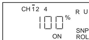
**CH** - výběr kanálu pro nastavení požadované polohy serva (nebo pro nastavení směru či zapnutí/vypnutí funkce SNP ROL
